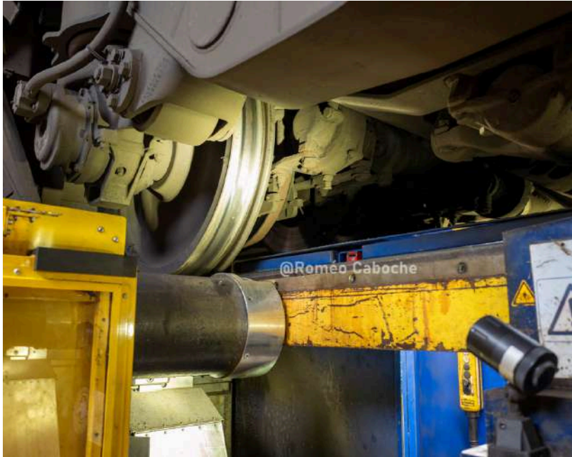
La machine de reprofilage vue de près
