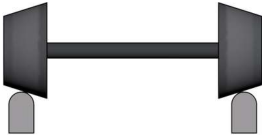
Illustrations de la conicité des roues d'un train - fr.etudes.ru/etudes/train-wheelset
