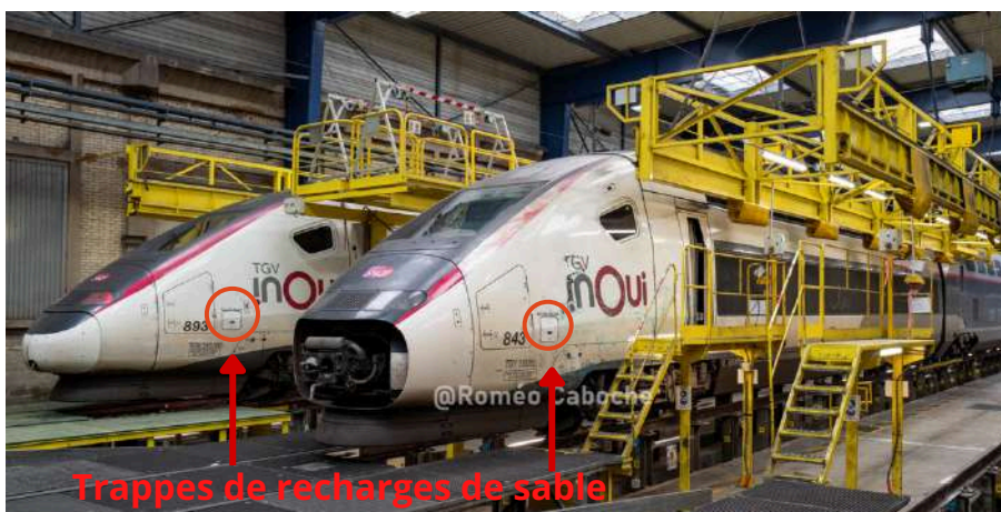
Deux rames TGV 2N2 InOui en cours de maintenance à Châtillon-Haut.
