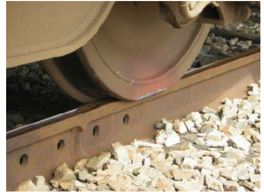
Une roue lourdement abîmée à cause d'un blocage de cette dernière lors d'une phase de freinage
