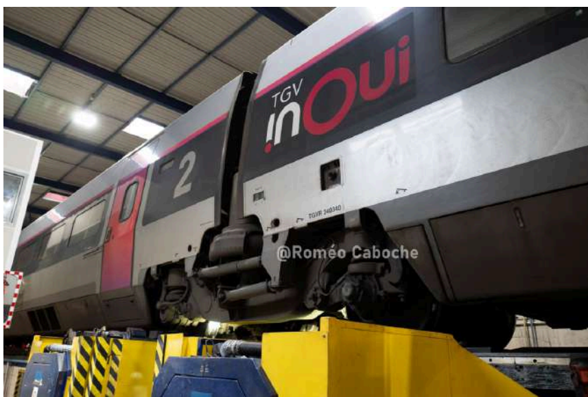
Une machine de reprofilage en action, qui efface les fissures d'un essieu. Les têtes de reprofilage sont situées sous leurs essieux respectifs, derrière ces caches jaunes.
